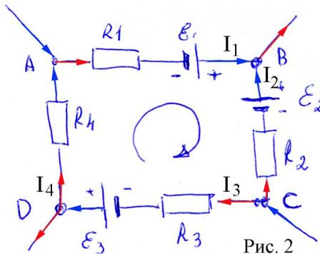
Так, например, в случае обхода по часовой стрелке замкнутого контура ABCDA, изображенного на рис. 2, уравнение (2) запишется так:
