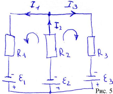
**Решение.** Мы снова видим хорошо известную нам схему, состоящую из двух узлов и трех параллельных ветвей. Составим соответствующую схеме систему уравнений:
